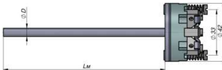
Датчики температуры с термометрической вставкой
