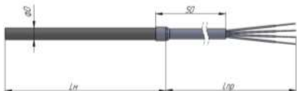
Термопреобразователь с проводами «А», без элементов крепления
